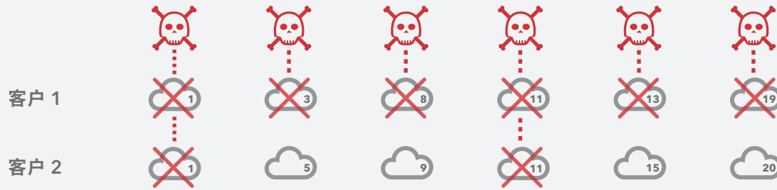
图 2：每个 Edge DNS 客户都在高性能和高可用性云的唯一组合上获得名称服务器，从而尽可能减少针对其他客户的攻击造成的附带损害。
