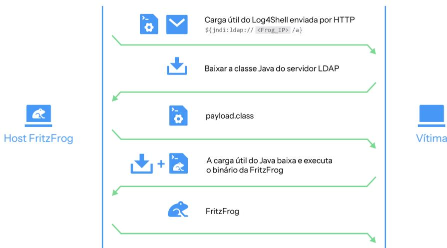
Fig. 8: processo de exploração Log4Shell da FritzFrog
