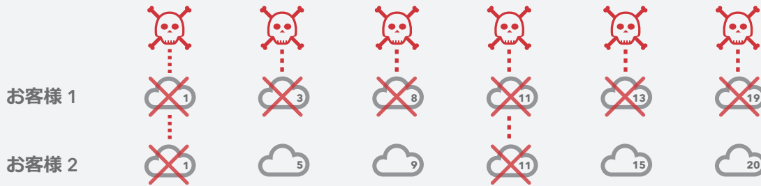
図 2 : Edge DNS は、パフォーマンスクラウドと可用性クラウドの固有の組み合わせとしてお客様にネームサーバーを提供することで、他のお客様への攻撃からの巻き添え被害を最小限に抑えます。
