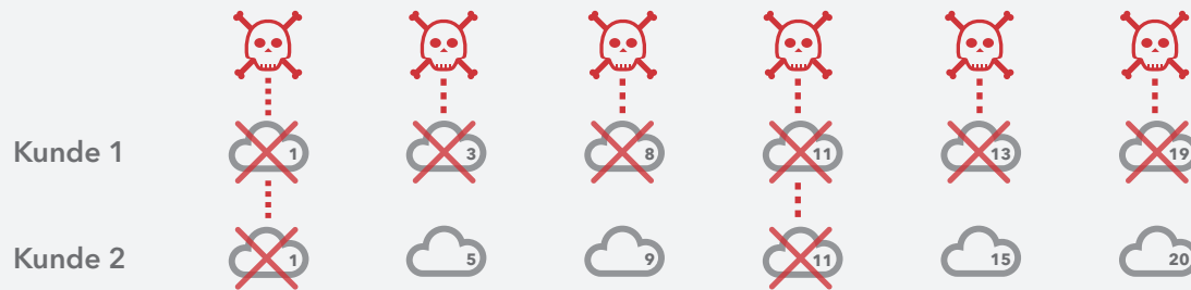
Abbildung 2: Jeder Kunde von Edge DNS erhält Nameserver in einer einzigartigen Kombination aus Performance-Clouds und Verfügbarkeits-Clouds. Dies minimiert die Kollateralschäden bei Angriffen auf andere Kunden.
